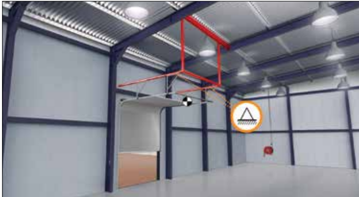
Zusätzliche Haltekonstruktion an der Decke
